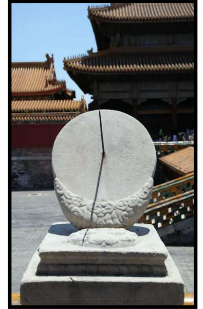
«Rigui », Pekin'deki ekvatoryal Güneş saati (M.S. 600 civarı).
